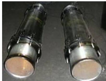
Сальниковые компенсаторы устанавливают в выдвинутом положении на полную длину хода, которая зависит от компенсирующей способности, с зазором между упорным кольцом на стакане и упором внутри корпуса. Этот зазор необходим для компенсации изменения длины трубопровода в связи с возможным понижением температуры труб после установки компенсатора. Установочные размеры односторонних и двусторонних компенсаторов указаны в нормалях.
